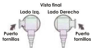
Ensamblada para instalación del lado izquierdo o derecho - pero puede ser fácilmente cambiada de lado en la instalación en campo. Cada conector contiene sus instrucciones.
