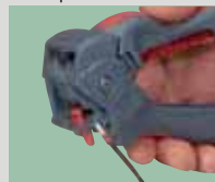
3 Inserte el conductor
